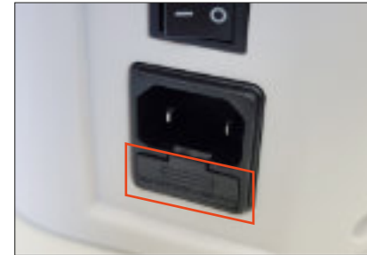
Bild 1 Pumpens säkring sitter bakom en lucka, placerad under anslutningen för el. Luckan knäpps lös med en liten skruvmejsel eller liknande.
