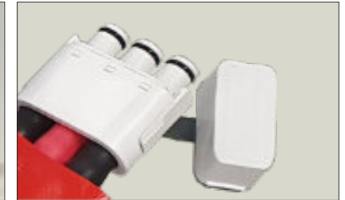
Bild 2 Pumpkoppling med transportlock Slangsetets kontakt har svarta gummiringar (sk O-ringar) vars funktion är att se till att kopplingen är tät. Om dessa ringar saknas, sitter fel eller är skadade kan luft läcka ut. Transportlocket bör användas när madrassen frikopplas från pump vid t.ex flytt av patient samt vid förvaring för att skydda kontakten.
