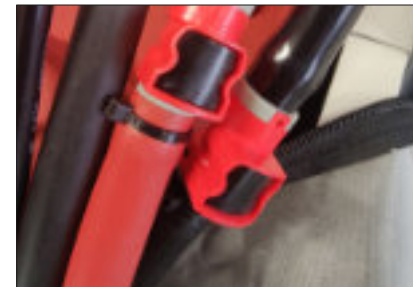
Bild 3 Slangsetets kopplingar Slangarna har tre snabbkopplingar som bör kontrolleras vid eventuellt larm för lufttrycksfall. Kontrollera så att kopplingarnas O-ringar inte saknas, sitter fel eller är skadade.
