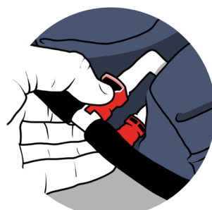
TOTAL AVLASTNING Alla cellerna kan enkelt, utan verktyg, frigöras för total avlastning.
