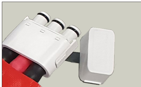
Bild 2 Pumpkoppling med transportlock
