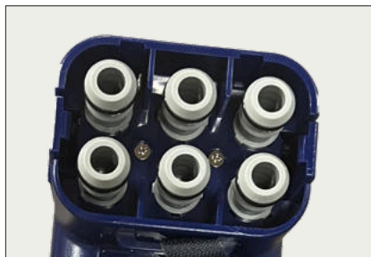
Bild 2 Pumpkoppling (med transportlock)
